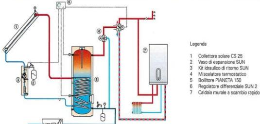
L'impianto di riscaldamento è stato alimentato a GPL in quanto si voleva un sistema automatico predisposto per comando a distanza. Il GPL è un combustibile oneroso, ma tendo conto che la casa sarà usata nel fine settimana ed è molto ben isolata, la scelta adottata risulta la più razionale. Inoltre è stata installata anche una caldaia a Pellet integrativa.
